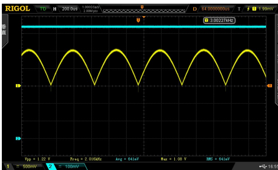
图 4.6 相位差为 0^\circ 时，输出的 PSD 波与直流分量
